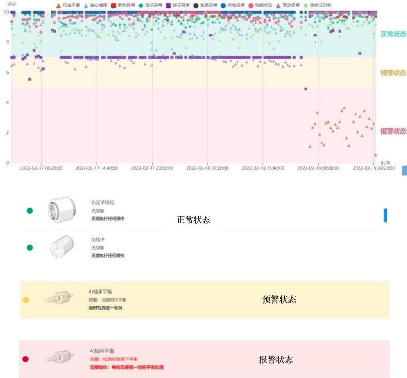
图 23 被监测电机设备故障诊断预警报警可视化
